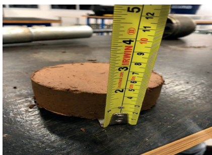
Figura 1a e 1b – Modelo da máquina utilizada para a compactação e Foto do corpo de prova após compactação.
