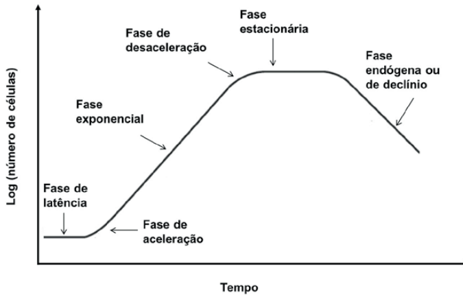
Figura 2 - Curva típica de crescimento dos microorganismos (lodo). Fonte: Monte et al. (2018).
