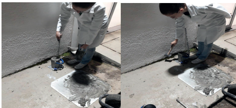
Figura 2 – moldagem dos corpos de prova. (a) adensamento; (b) regularização da superfície (FONTE: Próprio autor).
