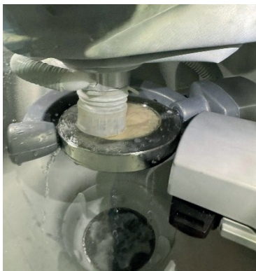
Figura 3 – Fresagem do disco de PMMA pelo sistema CAD-CAM na fresadora InLab MC X5 – Dentsply Sirona.
