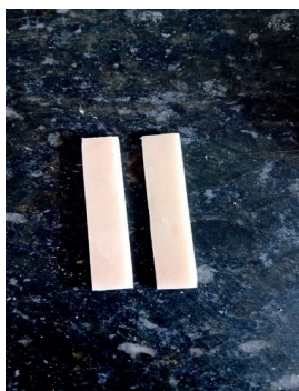
Figura 5 – Corpos de prova em PMMA fresados pelo CAD-CAM, polidos e isolados que servirão de matrizes retangulares, controlados por paquímetro.
