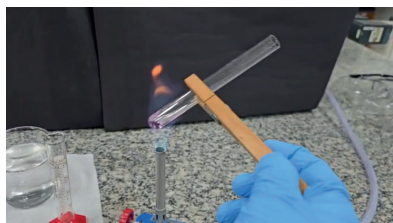
Figura 19. A reação de ionização da amônia. (a)- O esmaecimento da cor por causa do aquecimento; (b)- O retorno da coloração ao se colocar o tubo aquecido no banho de gelo, deslocamento do equilíbrio para os produtos (processo exotérmico).
