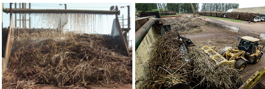
Figura 12: Processo de lavagem da cana-de-açúcar
