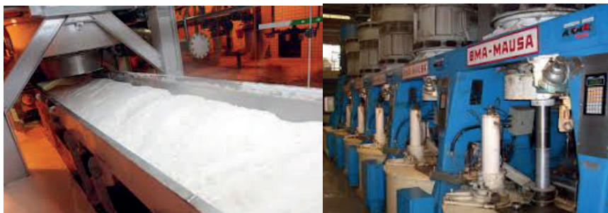
Figura 15: Clarificação e envasamento do açúcar cristalizado
