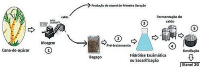
Figura 16: Representação esquemática da produção de E2G a partir da biomassa lignocelulósica
