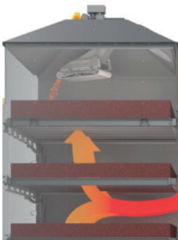
Figura 8 – Fluxo de ar no secador contrafluxo
