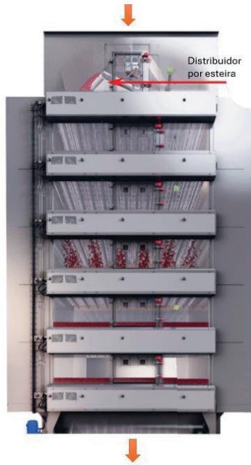
Figura 5 – Corte de secador contrafluxo
