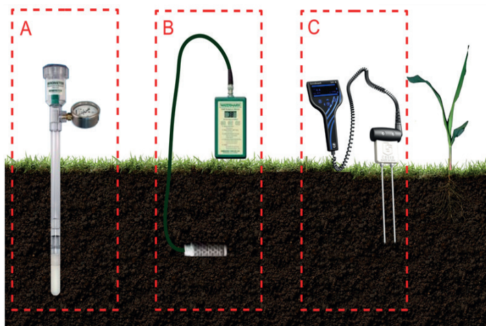
Figura 1. Equipamentos utilizados no manejo da irrigação via solo. A: Tensiômetros; B: watermark; c: FDR. Fonte: Irriga Global, 2021.
