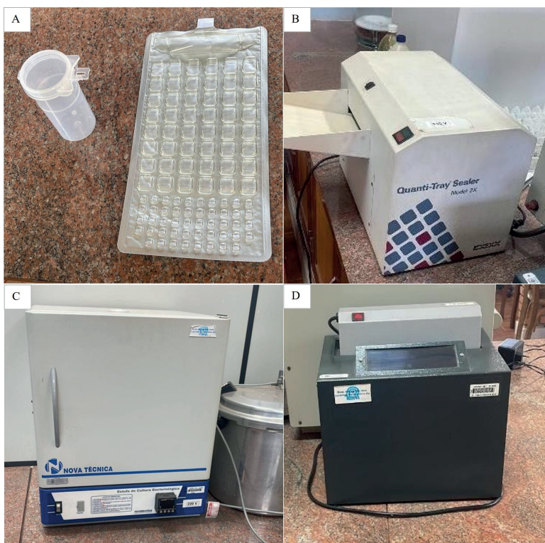
Figura 2. Materiais e equipamentos necessários para a determinação de coliformes. A: Cartela Quanty-Tray; B: Seladora; C: Incubadora; D: Equipamento de luz UV.
