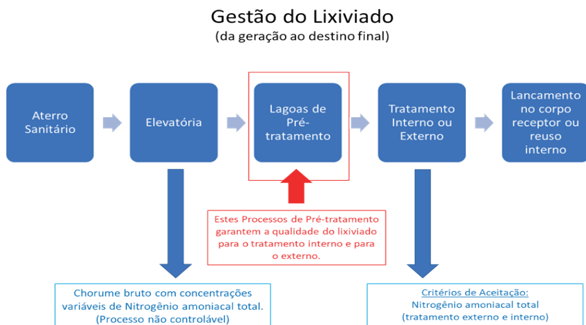
Figura 2 - Diagrama de Processo com Definição da Envoltória (Quadrado Vermelho) para Avaliação da Eficiência dos Processos de Pré-Tratamento do Chorume
