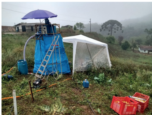
Figura 2. (A) Esquema de montagem e identificação dos componentes do simulador de chuva InfiAsper: 1. Estrutura metálica; 2. Bicos injetores de água e disco obturador; 3. Painel de controle; 4. Conjunto motobomba e reservatório de água; 5. Parcela coletora do escoamento. Adaptado de Macedo et al. (2021). (B) Simulador montado no campo na área experimental em Nova Friburgo. Foto: Nivaldo Schultz.
