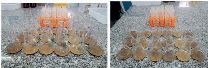
Fotografia 4. Extrato de solo após agitação contendo a esfera de vidro (4a) e sem a presença da esfera (4b)
