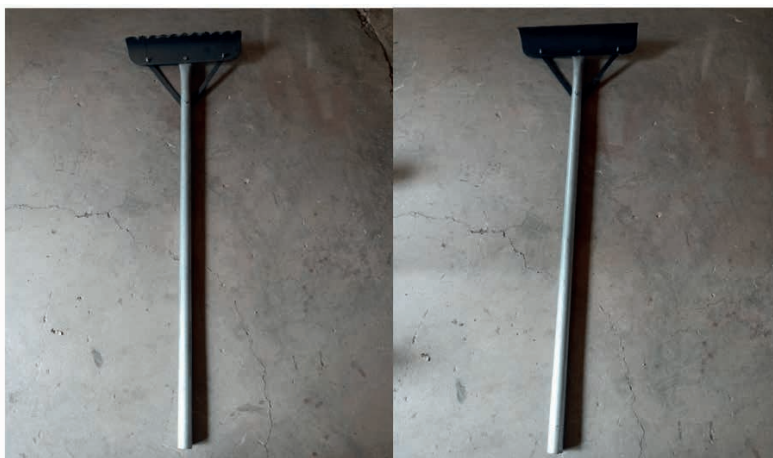
Figura 4.27 Azadones con modificaciones (longitud de timón, doble ancho de trabajo y base de corte en dentada y plana.
