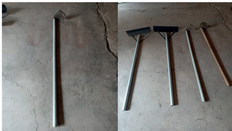
Figura 4.28 Azadones con modificaciones (longitud de timón, doble ancho de trabajo y base de corte en dentada y plana.
