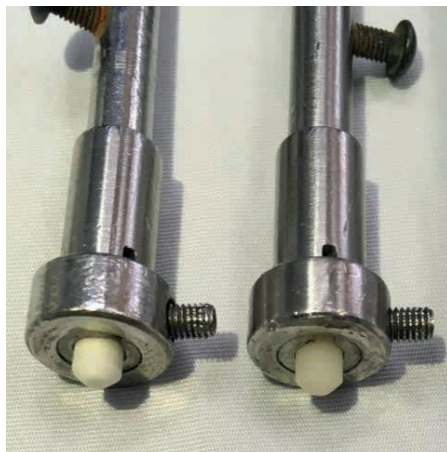
Figura 13 – Pistões adaptados nos mandris: esteatita e PIC
