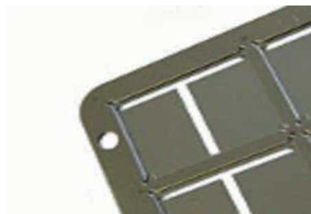
Figura 3.6 Mascara do LOEM da PUC-Rio utilizada para depositar a porta dos OFETs. Figura retirada da referência (Ossila, 2016).
