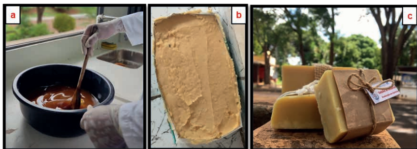
Etapas: (a) Produção do sabão; (b) Sabão em processo de maturação; (c) Sabão pronto. Fonte: Elaborado pelos autores, 2025.
