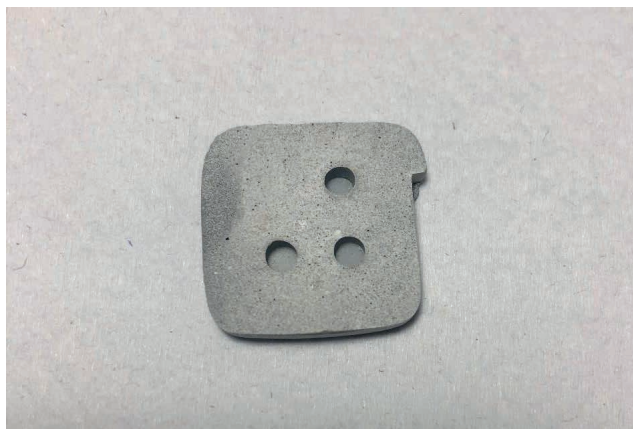
Figura 8 – Espécimes após a remoção da cera em forno
