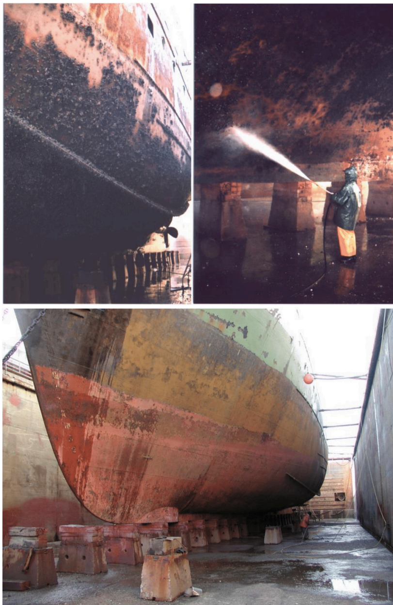
Figura 21. Limpeza (remoção do “biofouling”) do casco de um navio para aplicação de um novo Sistema Antivegetativo (Estaleiros de Aveiro, Portugal).
