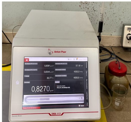
Figura 4: Densímetro Anton Paar empregado para a determinação da densidade das amostras de petróleo, essencial para os cálculos do volume e fator de encolhimento.
