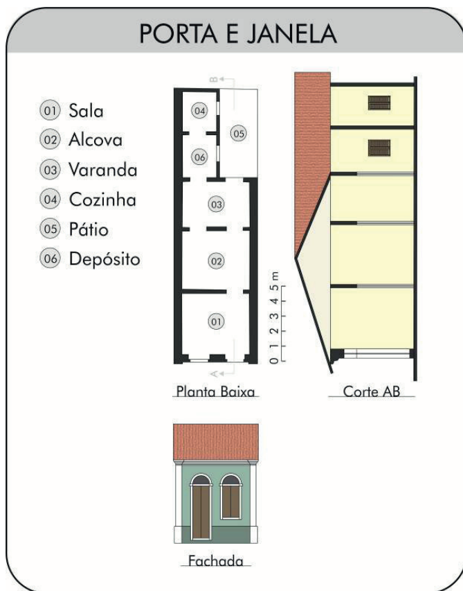
Figura 17: Desenho esquemático de fachada, corte e planta baixa de uma porta-e-janela. Fonte: Adaptado de Silva Filho, (1998).
