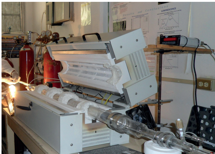
Figura 4. Sistema de depósito por vapor químico actualmente instalado en el laboratorio (CVD, por sus siglas en inglés).
