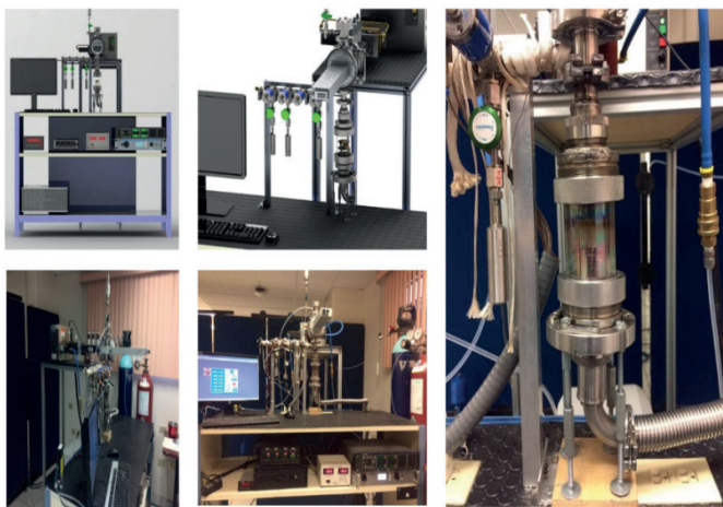
Figura 28. Sistema ALD asistido por plasma completo y funcional.
