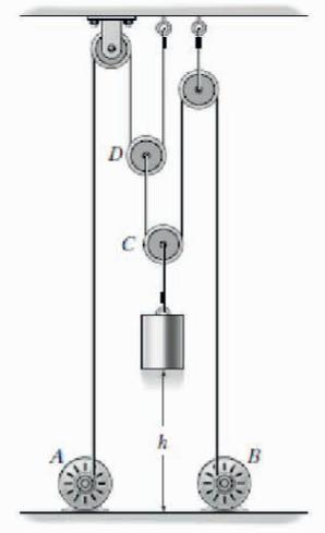
Si los motores  $A$  y  $B$  tiran de los cables con una aceleración de  $a=(0.2t)m/s^2$ , donde  $t$  está en segundos, determine la rapidez del bloque cuando alcanza una altura  $h=4m$ , partiendo del reposo en  $h=0m$ . Incluso, ¿cuánto tiempo se tarda en alcanzar esta altura? (Hibbeler, 2004-2010-2016).
