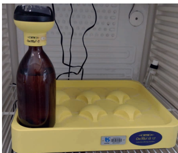
Figura 28- Conjunto garrafa e sensor eletrônico
