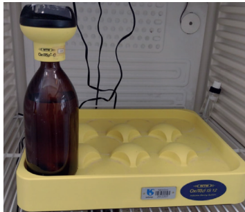
Figura 28- Conjunto garrafa e sensor eletrônico
