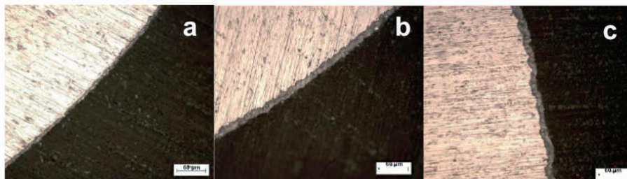
Figura 4 – Micrografias por Microscópio Óptico com aumento de 500x para: a – 1 minuto de tratamento; b – 8 minutos de tratamento; c – 16 minutos de tratamento.
