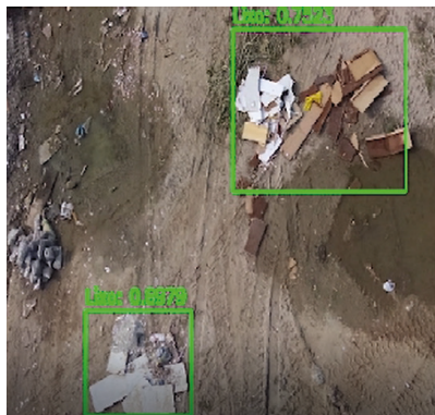
Figura 2 - Caixas delimitadoras de objetos detectados pela YOLO e seu respectivo valor de confiança
