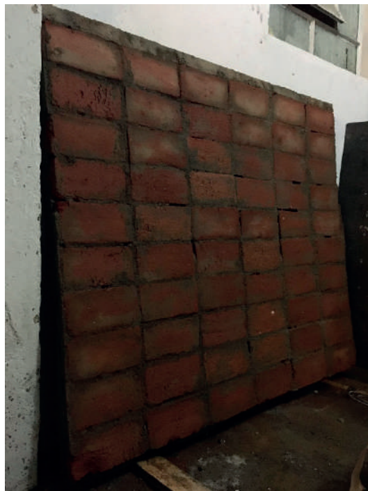
Figura 14. Foto da peça pronta, após cura e raspagem. Acervo do Autor
