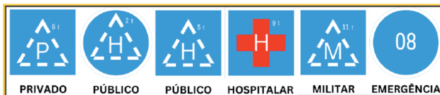
Figura 11 – SH de identificação de heliponto. Desenho do autor sem escala
