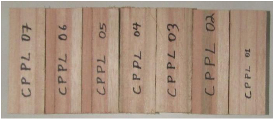
Figura 1 - Corpos de prova para ensaios de rigidez da MLC de Eucalyptus urograndis .
