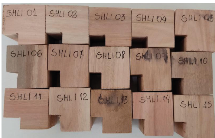
Figura 8 - Amostra para ensaio de cisalhamento paralelo às fibras da MLC de Eucalyptus urograndis .
