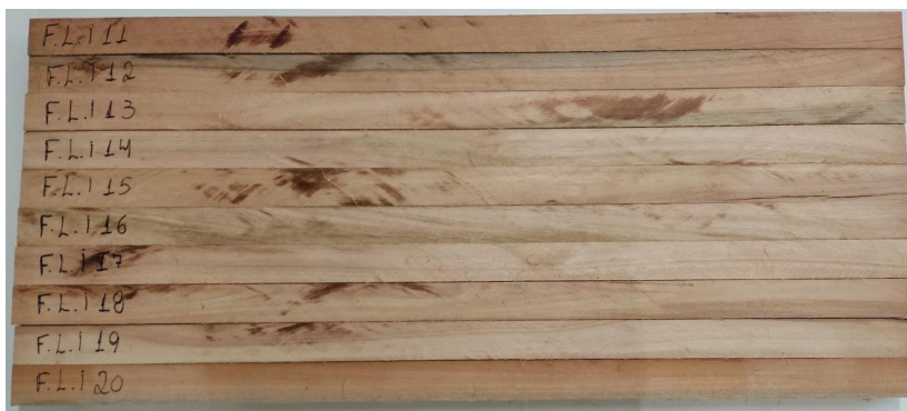
Figura 2 - Amostra de MLC ensaiadas à flexão.
