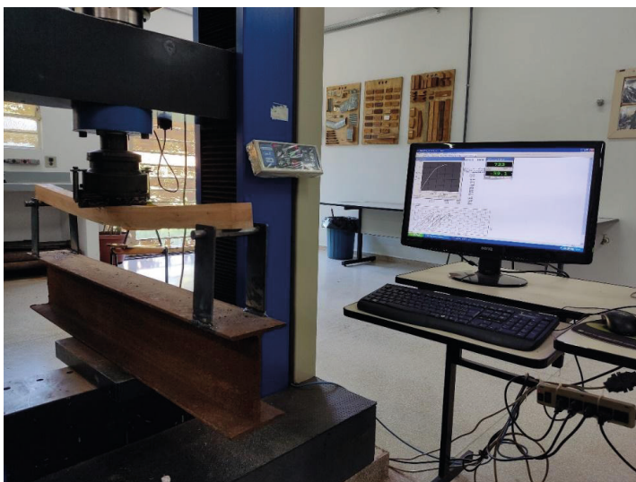
Figura 4 - Ensaio a flexão da MLC de Eucalyptus urograndis .
