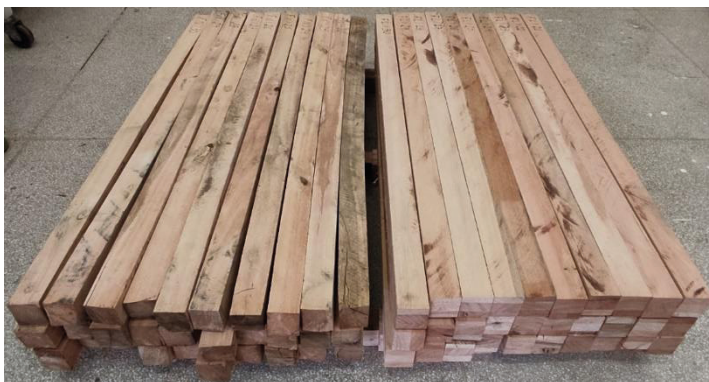
Figura 3 - Aspecto dos corpos de prova de ensaio a flexão da madeira natural (esquerda) e MLC (direita)
