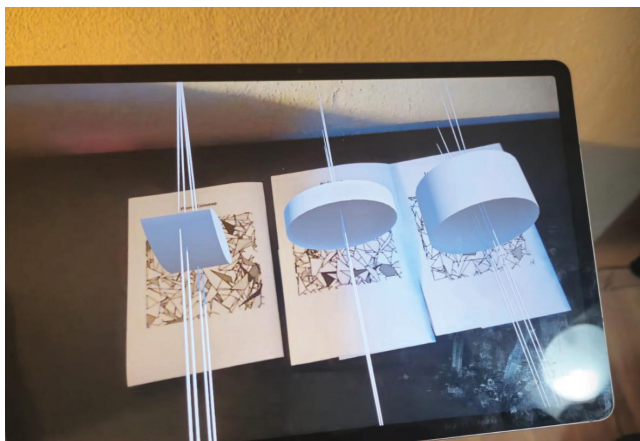
Figura 11. Visualização dos raios de luz passando pelas 3 lentes.
