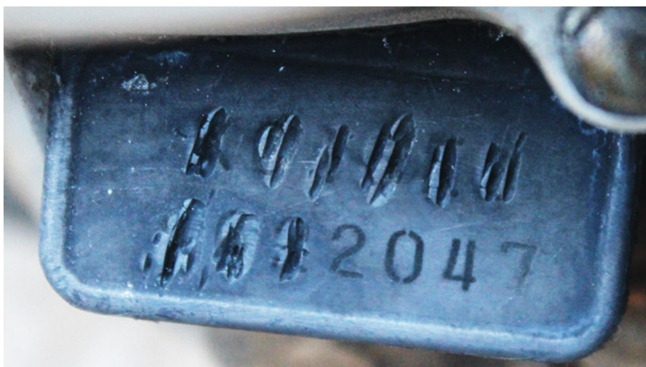
Figura 08. Evidenciação da sequência alfanumérica do motor após aplicação ácida (KC16E19022047).
