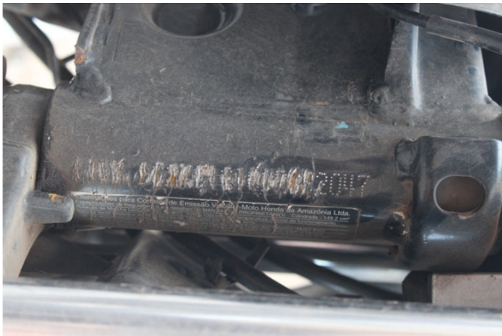
Figura 06. Supressão quase integral da sequência alfanumérica do NIV (chassi).
