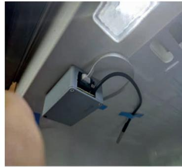
Figura 6. Dispositivo interno IoT del refrigerador. Fuente propia.
