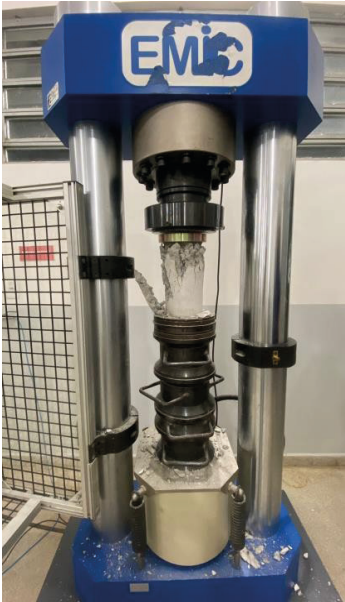
Figura 8: Ensaio de compressão axial. Fonte: Próprio Autor, 2024.
