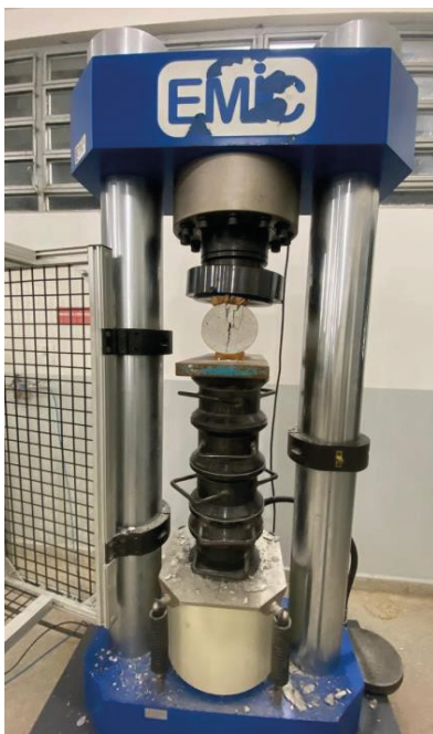
Figura 8: Ensaio de tração por compressão diametral. Fonte: Próprio Autor, 2024.
