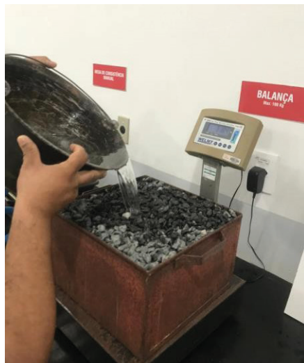
Figura 3: Pesagem do agregado gráudo úmido. Fonte: Próprio Autor, 2024.
