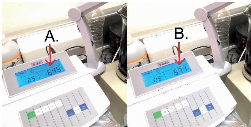
Figura 82. Potenciometro calculando pH en un líquido. A. Medición de líquido sin acidificar (valor 6,45). B. Medición de líquido con sustancia ácida (valor 5,71).
