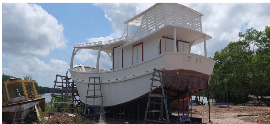
Figura 4. Lancha com o casco de plástico-alumínio revestido de fibra.
