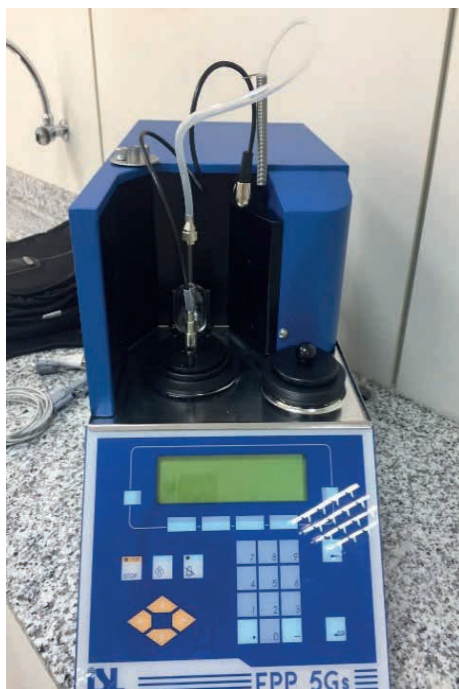
Figura 10 - Equipamento para medição do Ponto de Entupimento de Filtro à Frio modelo FCC 5Gs.
