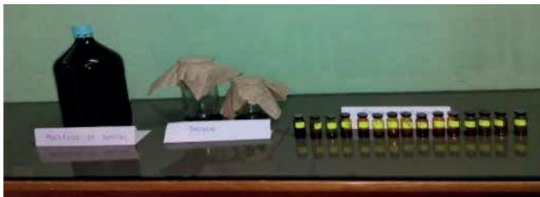
Fig. 2: Obtención de concentraciones a partir de macerado de café y palta en alcohol de 70% Fuente: Propia
