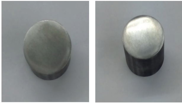
FIGURA 3. Se muestra en la imagen una vista de la misma superficie antes y después del electropulido en acero SAE 1040
