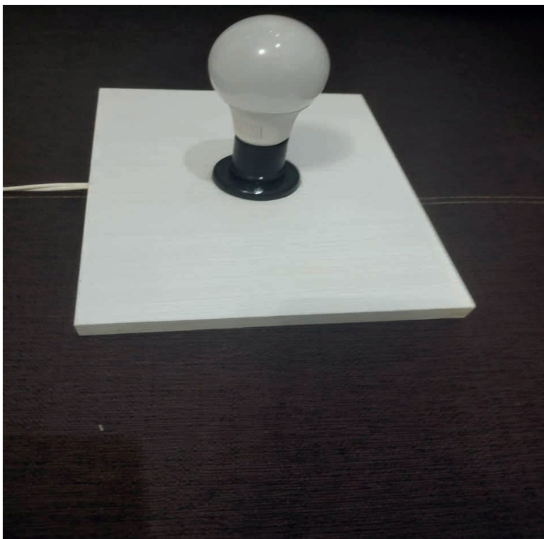
Figura 4: Lâmpada para simulação do Sol.
