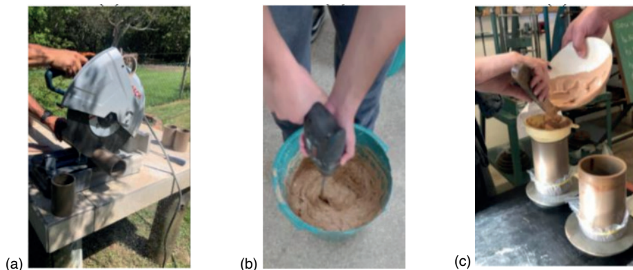
Figura 3: Moldagem dos CPs: (a) construção dos moldes; (b) realização da mistura; e (c) transferência gradual das misturas para os moldes.
