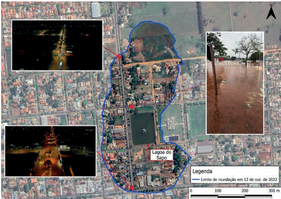
Figura 5 - Mancha de inundação para calibração do sistema
