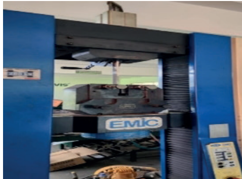
Figura 01 – Máquina Universal de Ensaio, tipo hidráulica, marca EMIC
