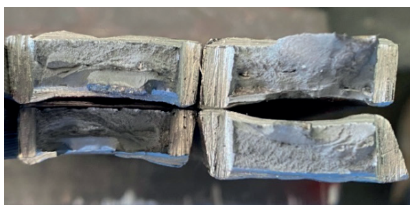
Figura 04 – Corpos de prova de Nick-Break após fratura
