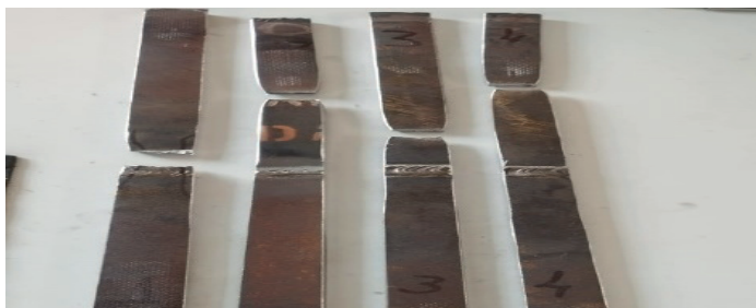
Figura 02 – Corpos de prova de tração fraturados
