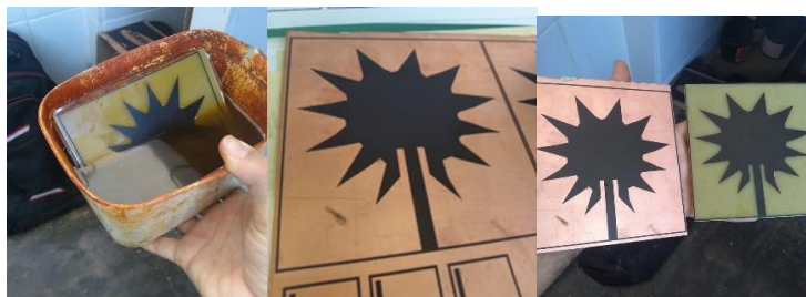
Figura 6 - Momentos de criação da antena. Placa de cobre adesivada e corrosão no ácido.
