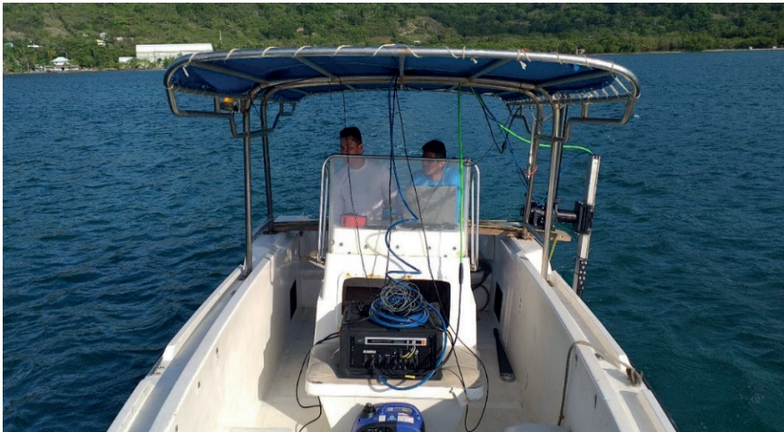
Figura 6 Embarcación tipo soundermax con ecosonda Kongsberg EM2040P.
