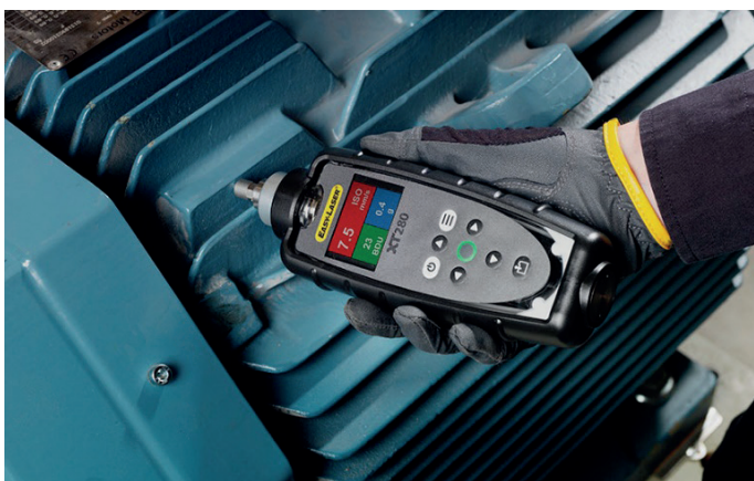
Medidor de Vibraciones
