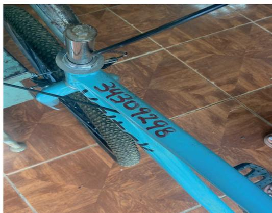
**34309299:** La bicicleta con código 34309299 también le hacía falta un poco de aire en las llantas y se le agregó para realizar el debido funcionamiento, además la pata y la cadena estaban flojas.
