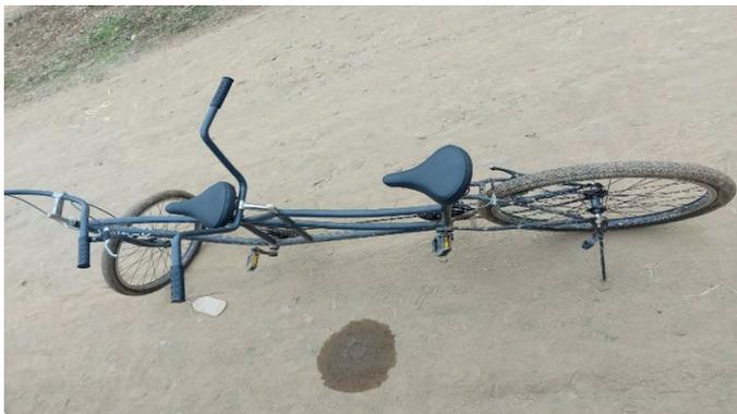
**34309298:** La bicicleta tándem con código 34309298 se encontraba en mal estado, estaba dañado el rache, mientras que a las llantas les faltaba aire para poder rodar con facilidad.
