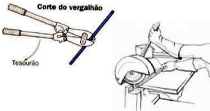
Figura 27 - Procedimento de corte das barras de ferro
