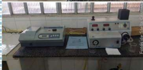
← Equipamentos para leitura. À esquerda, espectrofotômetro (leitura de P) e , à direita, fotômetro de chama (leitura de K e Na).
