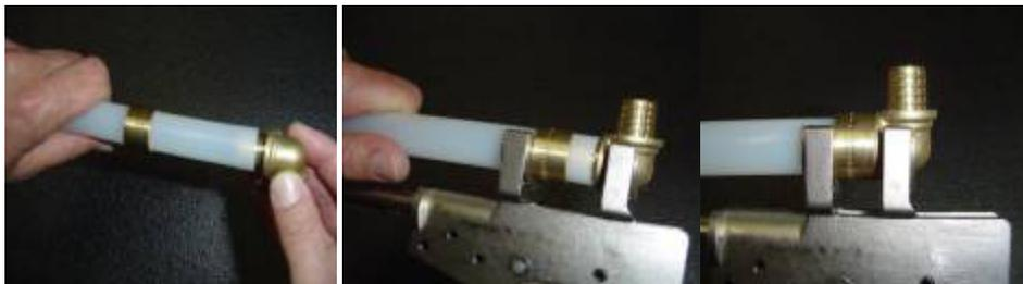
Introduzir a conexão no tubo. Deslizar o anel sobre a bolsa mediante a prensa.
