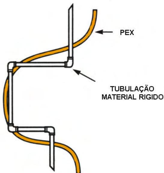
Figura. 23: Comparativo –Conexão x PEX –Fonte: ASTRA-SA –Palestra UNIP -jun-2005
