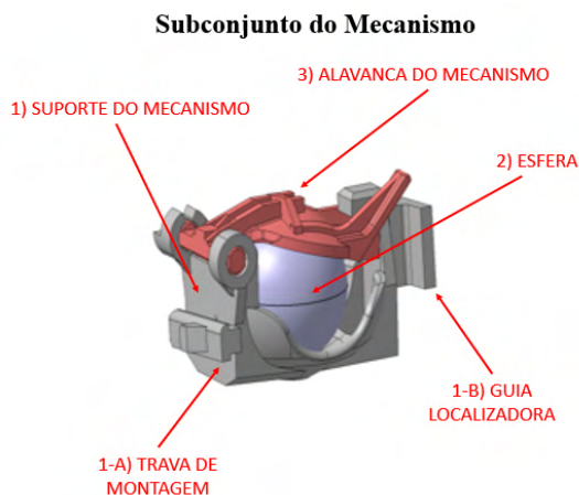
Figura 18 – Conjunto do mecanismo de bloqueio angular
