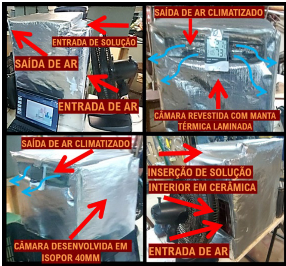
Imagem: Prática multidisciplinar desenvolvida para fins de demonstração didática do modelo experimental de câmara bioclimatizadora. Imagens referentes às testagens aplicadas no Laboratório de Edificações - Centro Paula Souza de Ribeirão Preto – junho de 2022.
