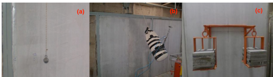
Figura 2– (a) Ensaio corpo duro (b) Ensaio corpo mole (c) Ensaio cargas suspensas
