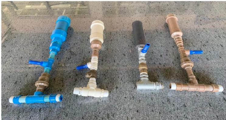
Figura 01 – Carneiros hidráulicos construídos
