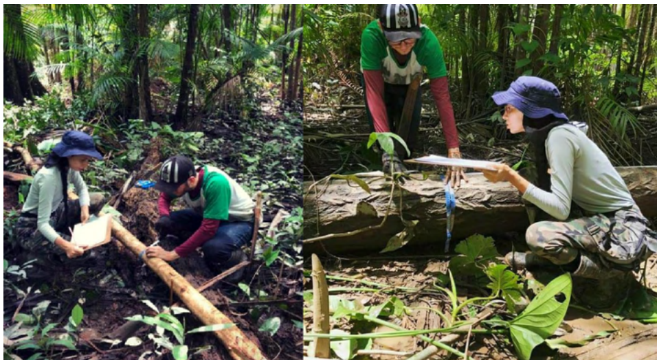
Figura 2: Medição de altura total e cubagem rigorosa das árvores caídas.
