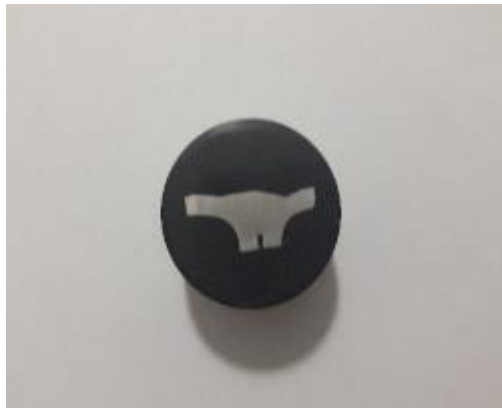
Figura 28 - Amostra 2 embutida, lixada e polida
