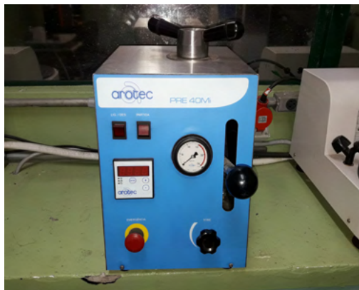
Figura 23 - Prensa utilizada para embutimento das amostras
