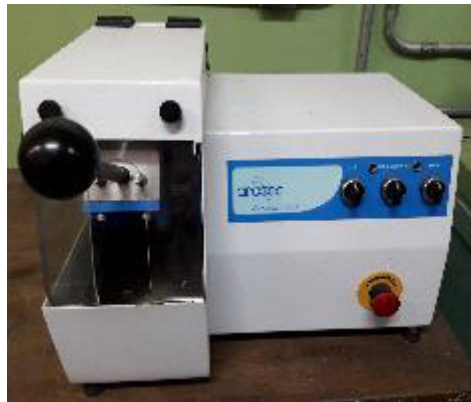
Figura 22 - Seccionadora convencional utilizada para o corte da amostra
