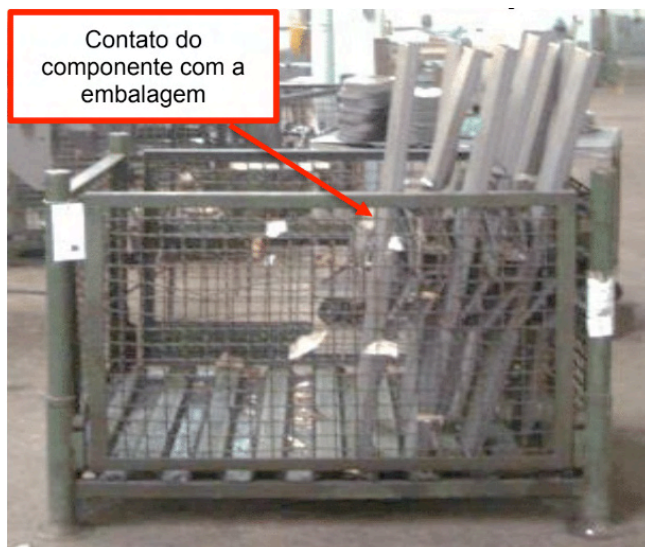
Figura 4 - Cesto aramado utilizado durante a movimentação interna dos componentes
