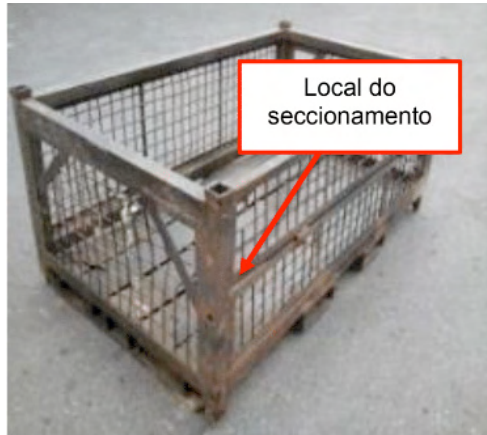
Figura 19 - Cesto aramado utilizado para retirada da amostra metalográfica
