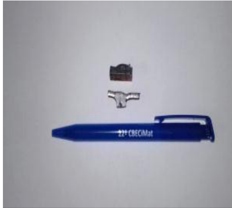
Figura 21 - Amostra de aço SAE 1010 seccionada da extremidade do cesto aramado
