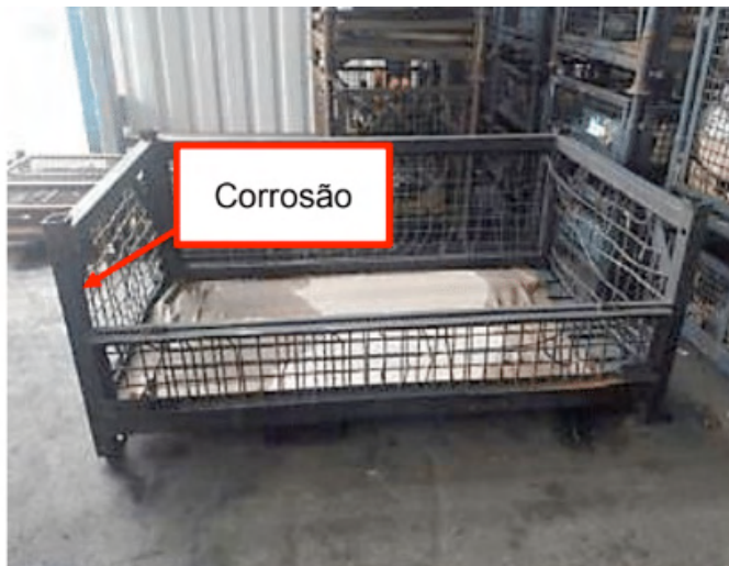
Figura 9 - Exemplo de um cesto aramado utilizado durante o processo de fabricação do item 22B.701.031 que apresenta corrosão em sua estrutura
