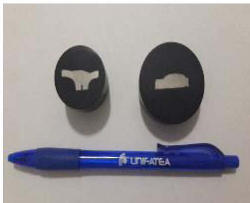
Figura 24 - Amostras seccionadas embutidas a quente
