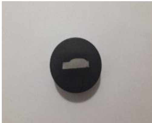
Figura 26 - Amostra 1 embutida e lixada
