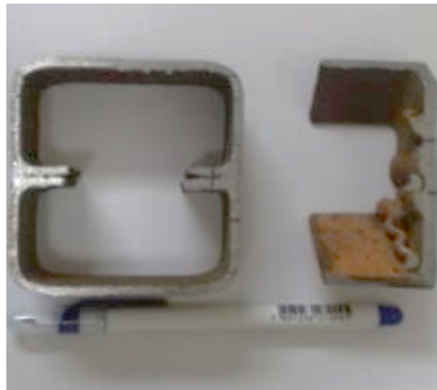
Figura 20 - Amostra de aço SAE 1010 extraído do cesto aramado
